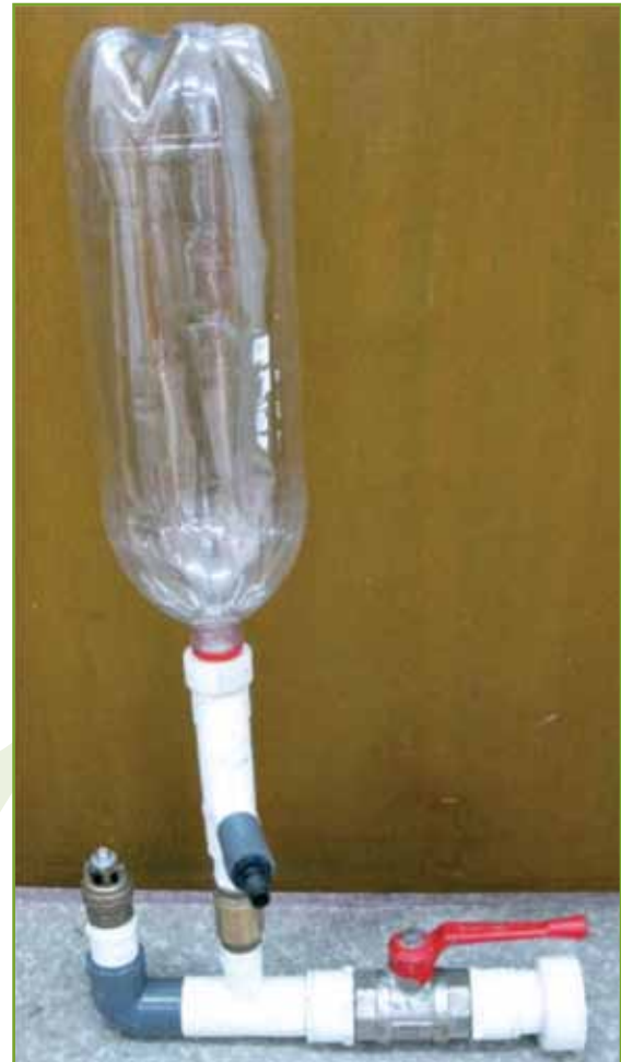
Tanque elevado y tubería de alimentación al ariete (1); ariete operando (2).
