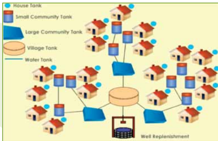
Red comunitaria de cosecha de agua (izq.) y reservorio de almacenamiento de la cosecha de agua lluvia (Australia). Fuente: http://si-usa.org/projects/rainwater-harvesting/
