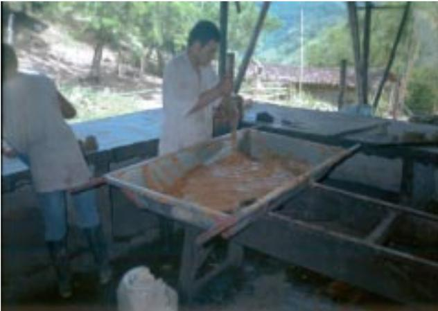
En esta operación la miel se pasa a unas bandejas – metálicas o de madera - en donde con la ayuda de palas pequeñas dos operarios baten la miel y la enfrían para pasarla finalmente a la zona de moldeo.
