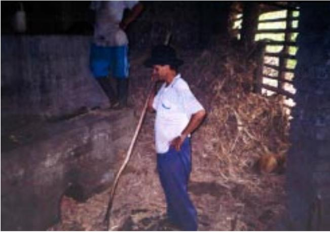
Del proceso de molienda se obtiene el bagazo, que es utilizado, luego de un secado natural, como combustible en la hornilla para generar las temperaturas necesarias durante el proceso.
