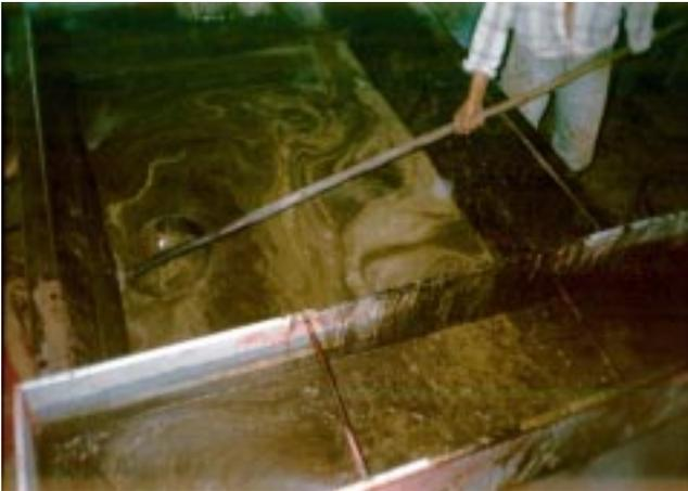
También se conoce comúnmente como “descachazado”, consiste en retirar con la ayuda de los “remellones” las impurezas sólidas suspendidas en el jugo y que repercuten en la calidad final de la panela. La limpieza se realiza por medios físicos de separación sencillos, a través de la adición de calor y agentes bioquímicos, como son las cortezas de especies vegetales que actúan como floculantes o aglutinantes (guasimo, cadillo o balso).
