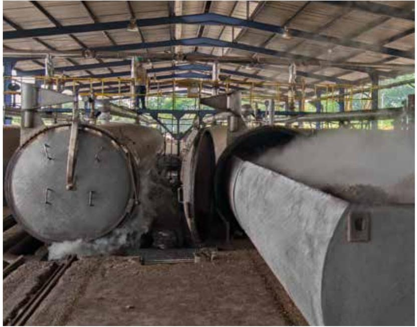
Recepción del fruto. En la esterilización, como primera etapa, someten los racimos de fruta fresca de palma a la acción de vapor saturado en cuatro autoclaves o esterilizadores a presiones relativamente bajas durante un tiempo de 55 a 80 minutos, aumentando y disminuyendo la presión.
